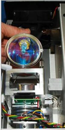
**Figure 25. Plug in Bulb**
