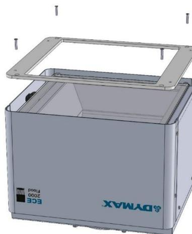
3. Installare le due piastre di montaggio (Figura 14) sull'alloggiamento del riflettore ECE 2000 usando quattro viti M3 da 16 mm e quattro rondelle piane M3.
