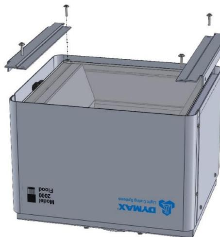
3. Installare il gruppo nell'otturatore manuale e fissarlo con le quattro viti 8-32 x 3/8" rimosse al punto uno (Figura 8).
